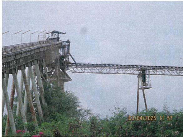
รูปที่ 10 ระบบสเปรย์น้ำบริเวณปลายสายพานของ ลานเก็บกองแร่
